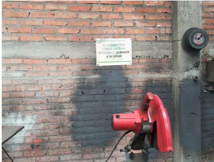
Ilustración 23 Falta de indicador de seguridad para utilizar el serrucho de banco.
