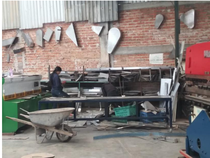
Ilustración 27 Falta de limpieza en el área de corte de lámina.
