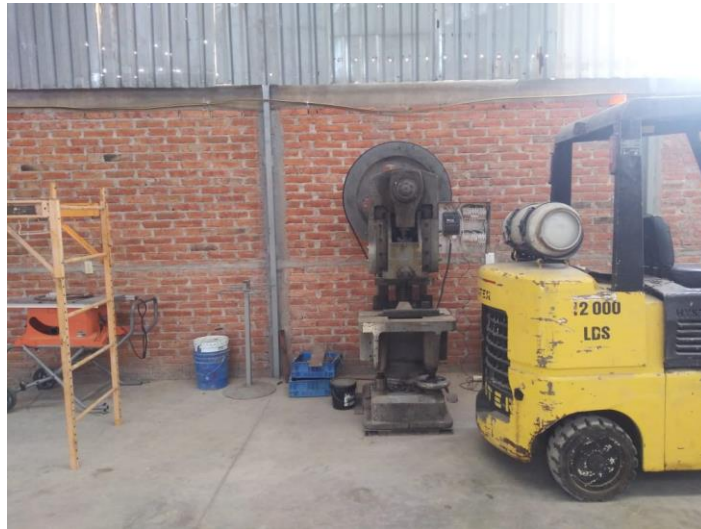
Ilustración 24 Falta de indicador de seguridad para utilizar el troque.
