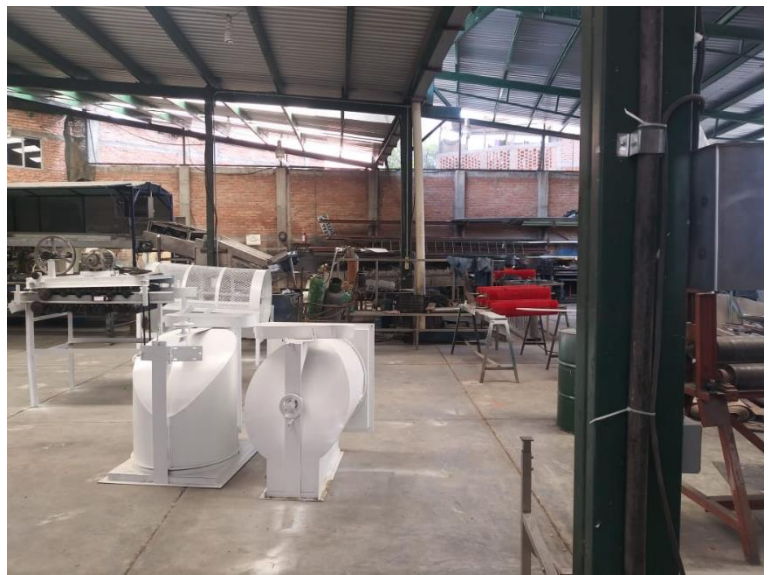
Ilustración 33 Ventiladores para limpiar ajo.
